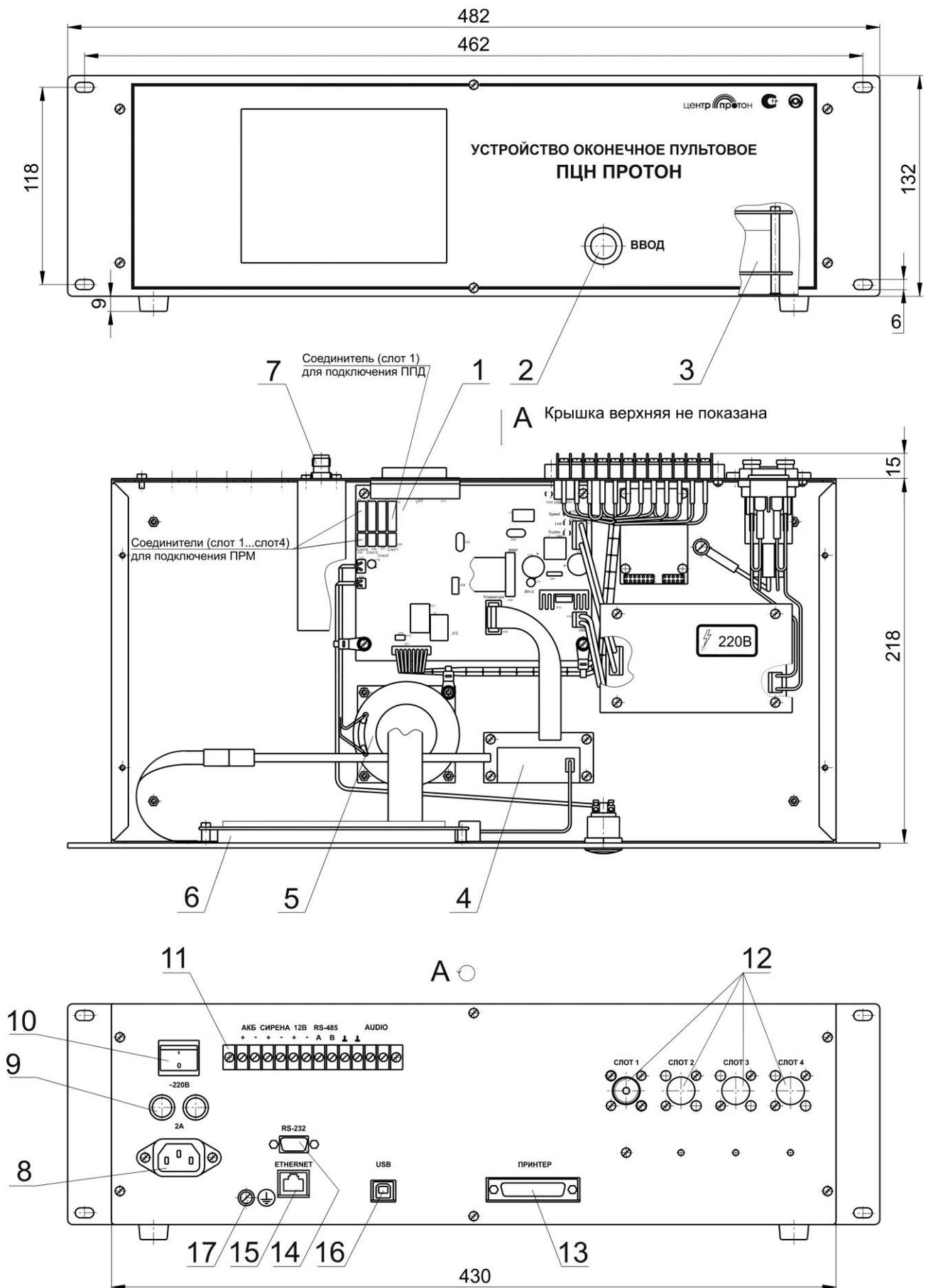
Рисунок 1 – пульт «Протон» с приемопередатчиком ППД (подключается только в слот 1)
