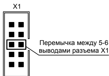
Рисунок 3 – Установка перемычки для возврата к заводским установкам
