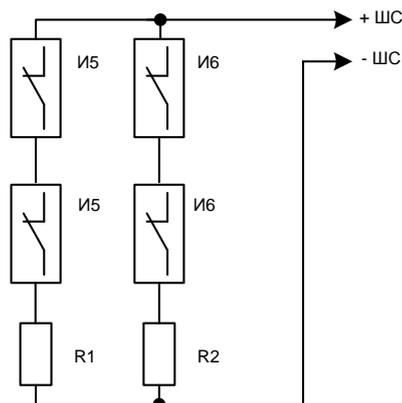
И5 - охранные извещатели с нормально замкнутой цепью. Извещатель, связанный с логическим ШС, для которого выбран метод подключения «ШС Х.1».
