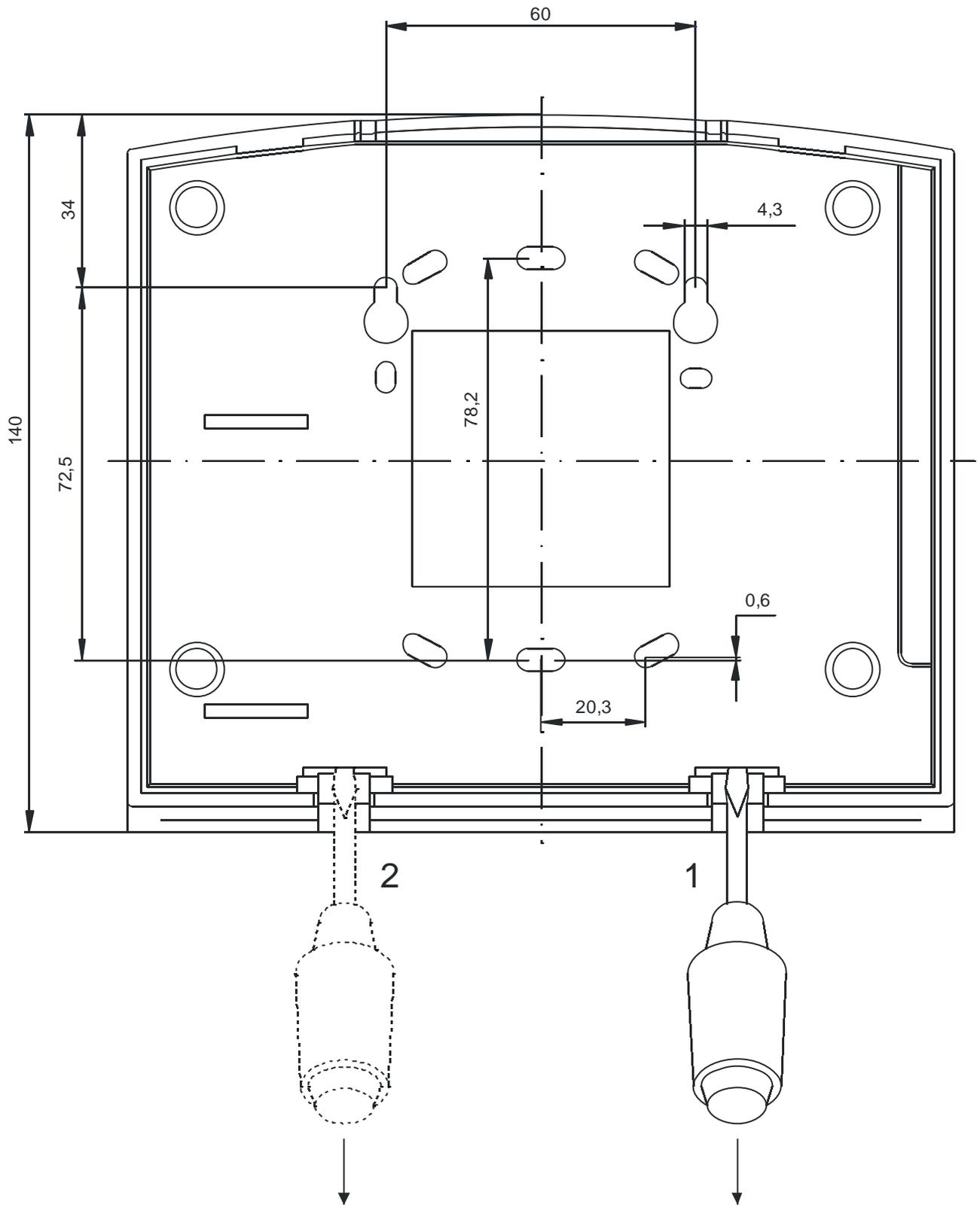
Рисунок Д.2 – Чертеж отверстий в корпусе для крепления пульта (вид сзади). Порядок разборки корпуса.
