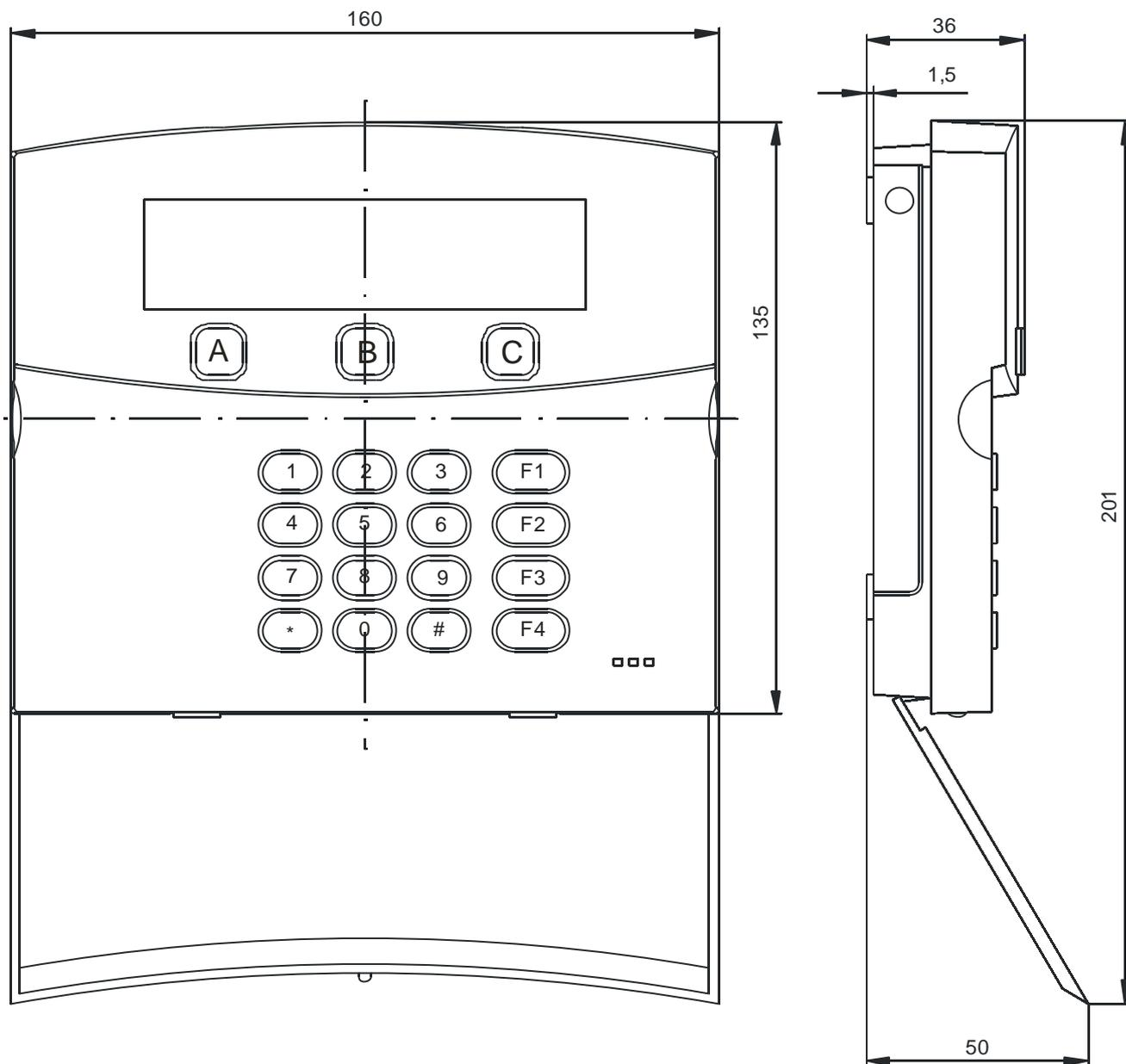
Рисунок Д.1 – Габаритный чертеж корпуса (крышка откинута).
