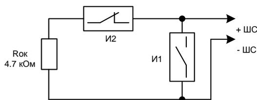
И1 - охранный извещатель с нормально разомкнутой цепью (включен параллельно).
