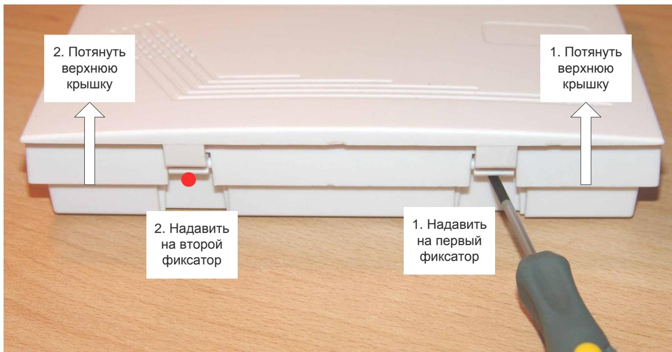
Рисунок Д.3 - Порядок снятия верхней крышки устройства в смонтированном на стену состоянии
