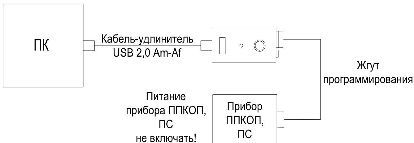
Рисунок 3 – Подключение программируемых устройств к программатору
